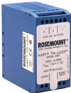
Volitelný 333 HART® Tri-Loop, signální převodník, který převádí HART signál na analogový signál.
